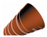
Tubo com duas paredes de tecido de fibra de vidro recoberto com silicone, com uma espiral de aço (entre as duas paredes do tecido).
